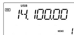
Geänderte Frequenz (14.123 MHz) wird nicht angezeigt, dafür jedoch die ursprünglich gespeicherte Frequenz (14.100 MHz).
