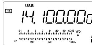
Die Frequenz wird in 1-Hz-Schritten abgestimmt.
