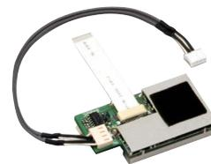
Stellt NF-DSP-Funktionalität wie z. B. die Rauschreduzierung und Auto-Notch zur Verfügung.
