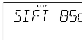
RTTY-Shiftfrequenz auf 850 Hz eingestellt. 850, 425, 200 und 170 Hz sind einstellbar.
