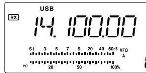
Die Frequenz wird in 10-Hz-Schritten abgestimmt.
