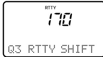
RTTY-Frequenzversatz auf 170 Hz eingestellt. 170/200/425 Hz sind einstellbar.
