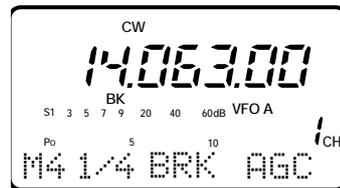
CW und Semi-Break-In-Betrieb ist eingestellt.
