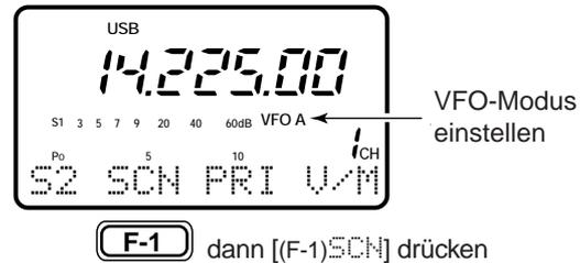
**Hinweis:** Falls die Suchlauf-Eckkanäle 1A und 1B mit den gleichen Frequenzen programmiert wurden, kann der Programmsuchlauf nicht gestartet werden.
