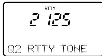
RTTY-Markfrequenz auf 2125 Hz eingestellt. 2125 und 1615 Hz sind einstellbar.
