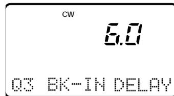
Eine Verzögerungszeit von 6,0 Punkte wurde im Quick-Set-Modus für Semi-Break-In-Betrieb eingestellt.
