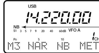
Wird eingeblendet, wenn der Störaustaster eingeschaltet ist.
